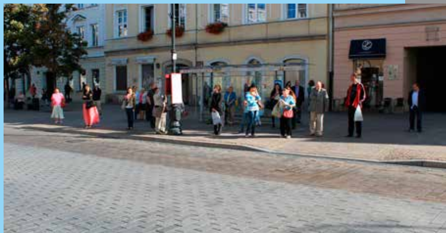
Przystanek autobusowy Uniwersytet 02. Zatoka autobusowa wymaga dodatkowej szerokości 3 m. Obniżenie krawężników w miejscach zjazdów indywidualnych do bram utrudnia wsiadanie i wysiadanie także w przypadku pojazdów niskopodłogowych.
